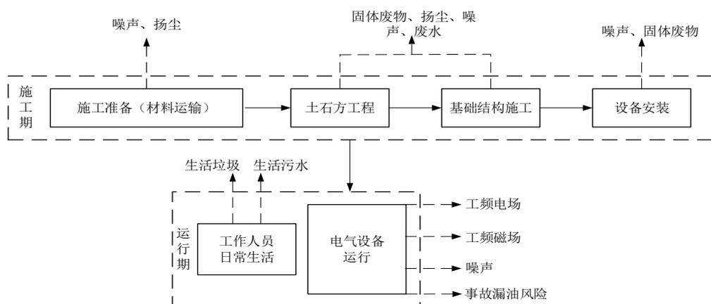
图 2-1 工艺流程及产污环节图
