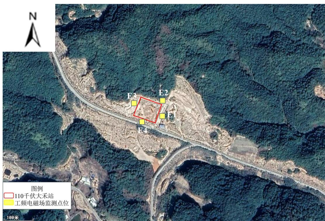
图 1 本工程测量布点图
