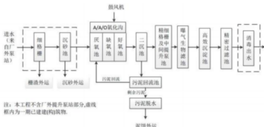
图 4-3 东源县城污水处理厂二期处理工艺流程图
