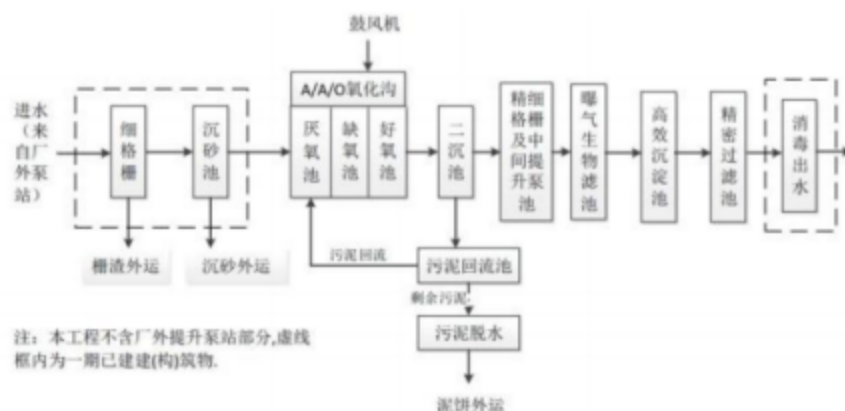
图 4-3 东源县县城污水处理厂二期处理工艺流程图
