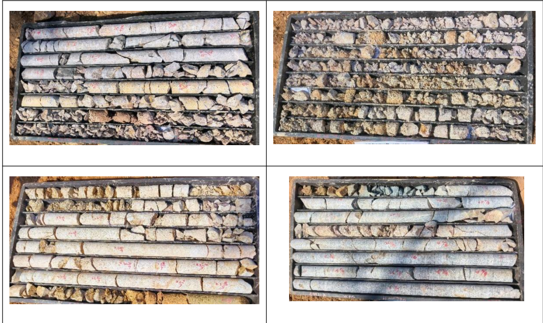
照片 4-7 矿体底板构造泥岩及二长花岗岩（ZK402 孔深 40.00m-74.00m）
