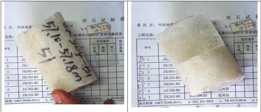
照片 4-3 石英岩矿石标本（取样工程 ZK304，取样深度 57.10m-57.18m）
