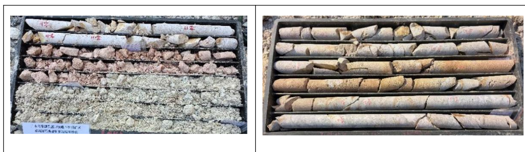
照片 4-8 V j1 夹石层特征 (ZK501, 孔深 26.20m-39.40m (左)、ZK502, 孔深 36.00m-42.00m (右))
