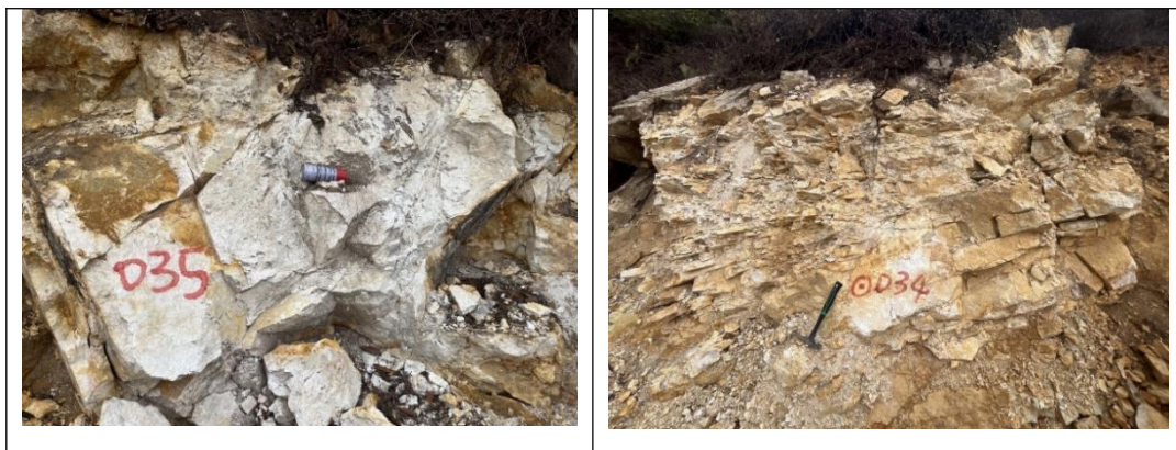
照片 2-5 NE、NW（左）及 SN（右）走向节理特征（镜头方位：左 350°、右 280°）
