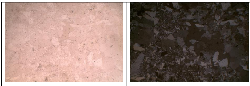
照片 4-4 石英岩矿石镜下特征（左单偏光，右正交偏光）
