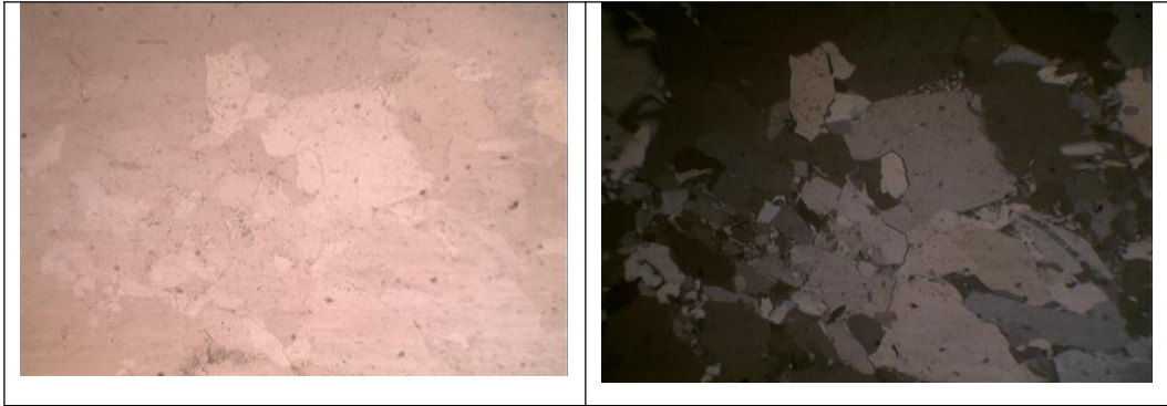
照片 4-2 石英岩矿石镜下特征（左单偏光，右正交偏光）
