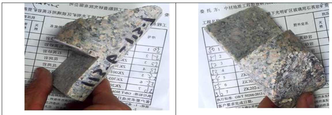
照片 2-6 细粒斑状二长花岗岩标本（取样工程 ZK001，深度 113.60m-113.70m）
