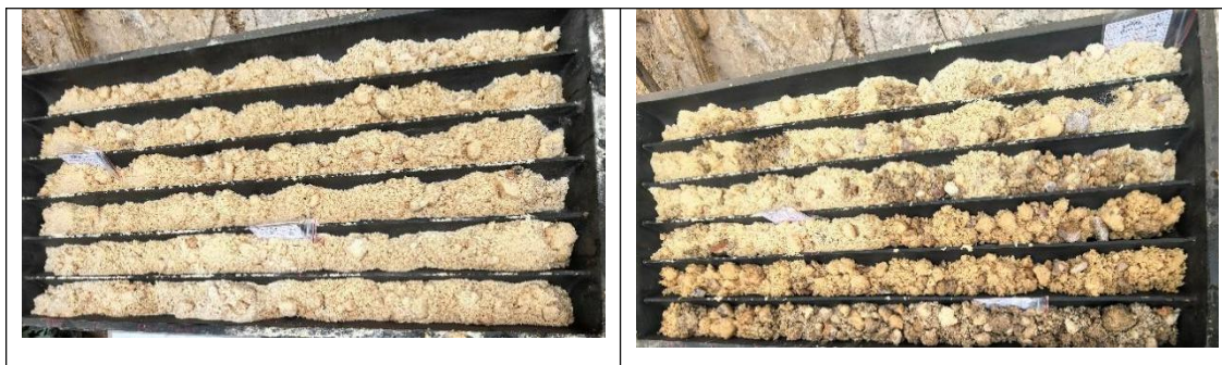
照片 2-2 ZK702 孔深 63.2m~78.2m 揭露 F_{1-1} 构造破碎带中的石英岩碎屑
