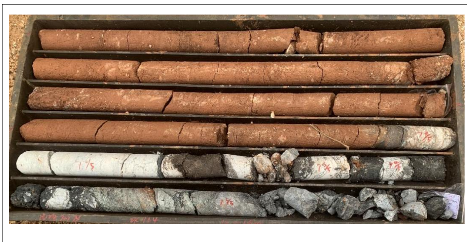
照片 4-5 矿体顶板红褐色泥岩 (ZK104 孔深 12.00m-18.00m)
