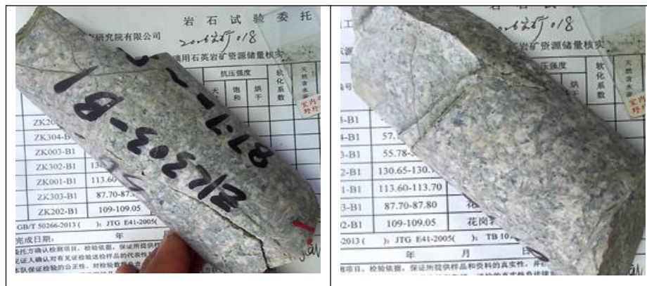
照片 2-8 碎裂碎斑花岗岩标本（取样工程 ZK303，深度 87.70m-87.80m）
