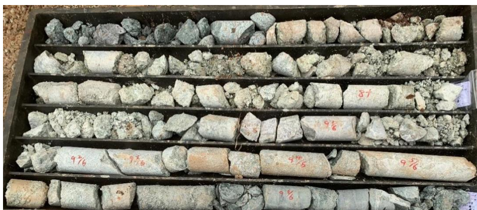
照片 4-6 矿体顶板构造角砾岩 (ZK104 孔深 18.00m-24.00m)
